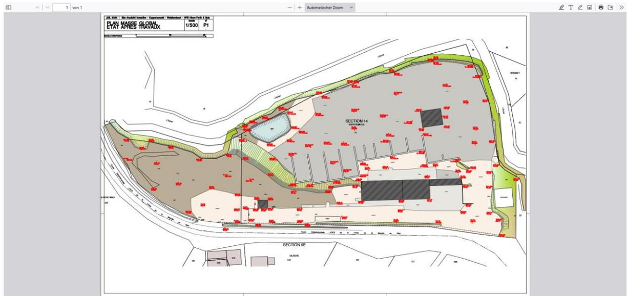
**Partie gris clair** : Partie inférieure de la plateforme avec **un peu plus d'1 hectare** de surface goudronnée, dédiée à la **transformation et au stockage** (donc imperméabilisée). Sur les **9 boxes en béton**, **3 boxes d'environ 730 m<sup>2</sup>** (dimensions intérieures) et **près de 7 m de hauteur** sont presque **entièrement couvertes**, idéales pour le **matériel à sécher ou déjà sec**.
